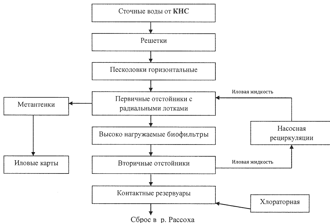
Рис. 1 — Схема работы городских очистных сооружений
